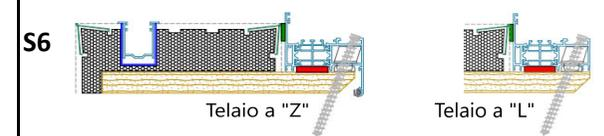
Spalla monoblocco per serramento scorrevole filo interno e guida esterna
