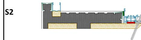
Spalla monoblocco per serramento battente o scorrevole in mazzetta e guida incassata
