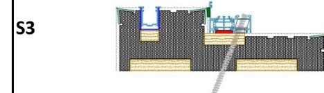
Spalla monoblocco per serramento scorrevole filo interno e guida incassata
