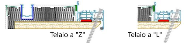
Spalla monoblocco per serramento scorrevole filo interno e guida esterna
