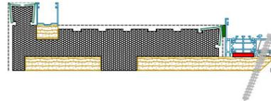
Spalla monoblocco per serramento battente o scorrevole in mazzetta e guida incassata
