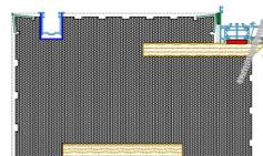
Spalla monoblocco per serramento battente o scorrevole centro muro e guida incassata
