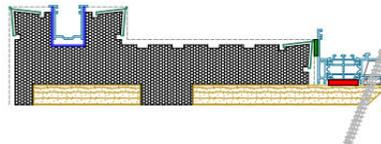
Spalla monoblocco per serramento scorrevole filo interno e guida sporgente
