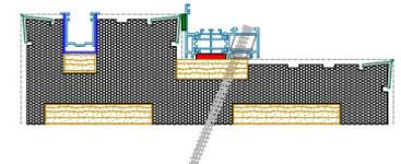
Spalla monoblocco per serramento scorrevole filo interno e guida incassata
